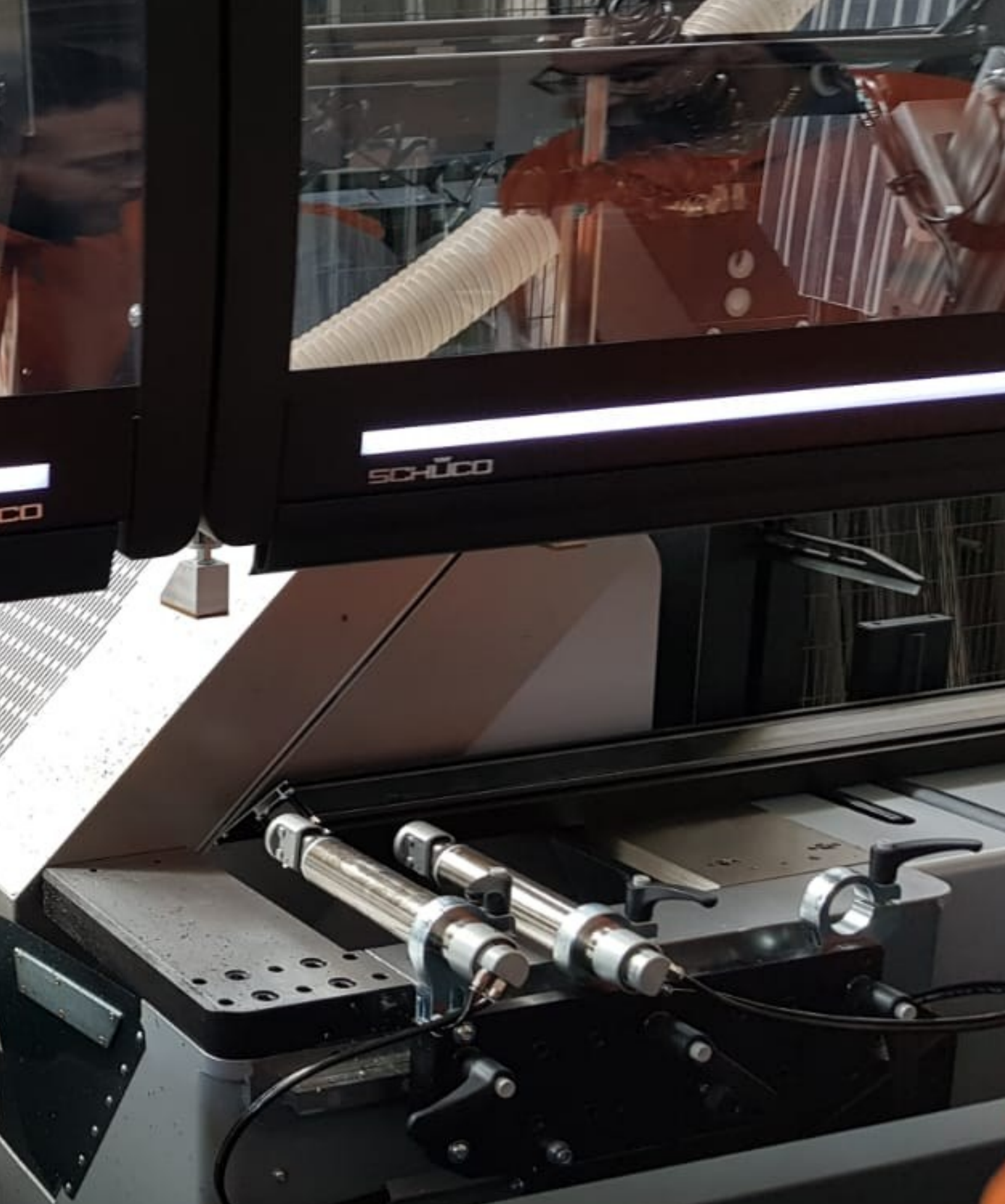
Dettaglio della troncatrice BLITZ 65 a due teste con spostamento motorizzato
